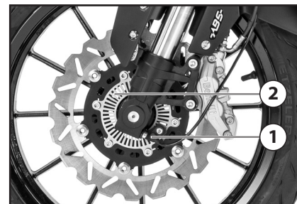
1. Sensor da roda dianteira 2. Rotor do sensor dianteiro
